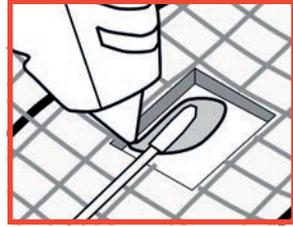
Puede ser necesario cavar una pequeña parte del contrapiso para acomodar el sensor dependiendo de la textura fina del elemento usado.
